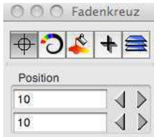
Hier kann die Position des Fadenkreuzes angegeben werden. Für viele Anwendungen wird sie einfach 0/0 sein. Die Koordinaten des Fadenkreuzes stellen eine Ausnahme dar, denn sie werden absolut in Bezug zum Ursprung des Fensters angezeigt (relativ zur linken unteren Ecke des Fensters).
