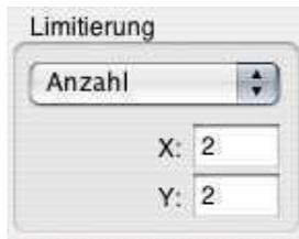
In diesem Teil des Panels wird angegeben auf welche Weise die Objekte zur Fertigung verteilt werden. Bei Auswahl von 'Anzahl' im Pop-Up Menu erfolgt die Verteilung durch Angabe der Stückzahl in X und Y Richtung. Bei Auswahl von 'Materialgröße', wird die angegebene Fläche ausgenutzt. In den beiden Feldern werden die passenden Werte zur Auswahl angeben.
