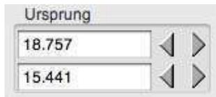
Hier wird die Position der Senkung angezeigt und eingestellt. Die Position ist das Zentrum der Senkung.
