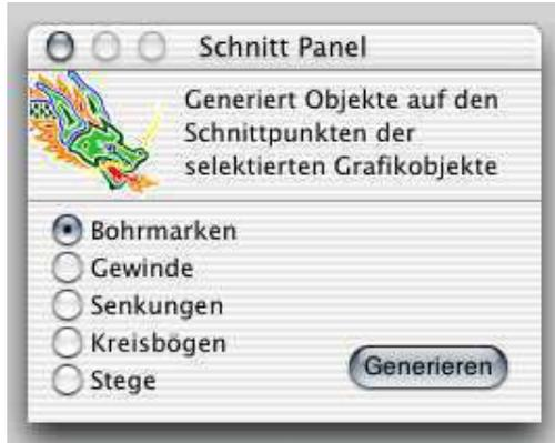
Das Schnitt-Panel wird verwendet um verschiedenartige Objekte auf Schnittpunkten bestehender Grafikobjekte zu generieren. Wenn Sie beispielsweise Bohrungen in einem konzentrischen Muster verteilen möchten, so können Sie einfach ein Muster aus Kreisen und Linien erstellen. Anschliessend können mit diesem Panel Bohrmarkierungen auf die Schnittpunkte plaziert werden.
