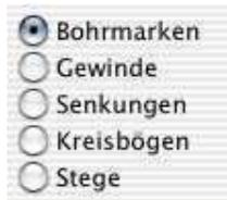
Hier wählen Sie die Art der Grafikobjekte, die Sie generieren möchten. Die Objekte werden mit Standardparametern auf alle Schnittpunkte gesetzt. Im entsprechenden Inspektor (siehe Abschnitt 3.6) können Sie die Parameter anschliessend nach Ihren Vorstellungen ändern.
