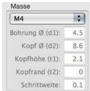
Dieser Bereich zeigt die Masse der Senkung. In dem Popup-Menu kann die Senkung nach Namen gewählt werden. Die Masse werden dann in den Feldern angezeigt.
