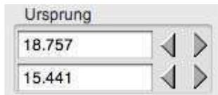
Hier wird die Position der Gruppe angezeigt und eingestellt. Dies ist die linke untere Ecke eines gedachten Rechtecks, welches die Gruppe mit allen Elementen gerade so einschliesst.
