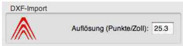
Hier kann die Auflösung für den DXF-Import eingestellt werden. Da dieser Wert im DXF-Format nicht vorgegeben ist, können verschiedene Programme unterschiedliche Auflösungen bei der Ausgabe verwenden. Geben Sie dieselben Auflösungen an, die Ihr CAD-Programm bei der Ausgabe der Datei verwendet hat. Übliche Werte sind auch ein Vielfaches von 25,4 oder 1. Siehe auch Kapitel [4.3](#).
