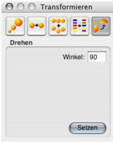
Hier können selektierte Grafikobjekte gedreht werden. Die Eingabe des Winkels erfolgt in Grad. Positive Werte drehen gegen den Uhrzeigersinn.
