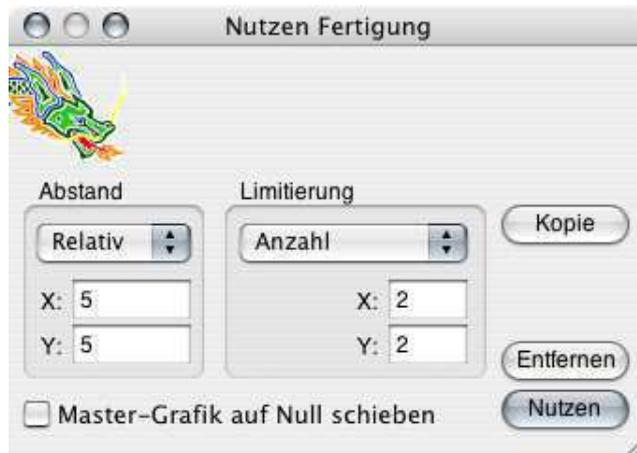
Das Nutzen-Panel (Werkzeuge▷Nutzen-Panel) dient zum Generieren eines sogenannten Nutzens. Die Arbeitsfläche der Gravieranlage wird dabei optimal ausgenutzt, um die vorhandene Grafik so oft wie möglich zu verteilen. Sie können also mehrere gleiche Objekte fertigen, ohne selbst die Objekte kopieren zu müssen oder nach jedem ausgegebenen Objekt den Startpunkt der Anlage neu justieren zu müssen.
