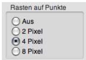
Hier kann gewählt werden, ob und in welchem Abstand die Mausposition beim Editieren von bestehenden Stützpunkten anderer Grafikobjekte eingefangen wird. Die Funktion erleichtert das exakte Konstruieren ungemein, da neue oder verschobene Grafikobjekte auf bestehende Grafikobjekte einrasten. Es können mit Hilfe dieser Funktion z.B. auch beliebige Hilfsraster (z.B. spiralförmig) aufgebaut werden, auf deren Knotenpunkte alle Grafikobjekte beim editieren einrasten.
