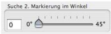
Bei zu starker Drehung des Werkstücks, kann es vorkommen, dass der zweite Markierungspunkt nicht im Kamerabild auftaucht. In diesem Fall, kann automatisch in einem Kreisbogen nach dem Punkt gesucht werden.
