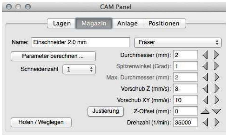
Hier finden Sie unter anderem einen Eintrag namens Z-Offset. Über diesen geben Sie die Höhendifferenz zu dem Werkzeug mit der grössten Länge ein (mit diesem muss dann auch der Wert Z Kontakt festgelegt werden). Wenn also das längste Werkzeug beispielsweise vom Anschlagring bis zur Spitze 38 mm misst und das aktuelle nur 30, dann müssen Sie bei Z-Offset eine 8 eintragen. Der Knopf Justierung dient dazu, den Offset direkt durch Ausprobieren zu ermitteln.
