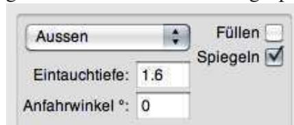
**Bohr-Durchmesser:** Allen Bohrlagen muss ein Bohrer passenden Durchmessers zugeordnet werden. Da die Bohrlagen erst beim Import angelegt werden ist erstmal kein Werkzeug zugeordnet. Auch die Eintauchtiefe muss bei den Bohrlagen gesetzt werden.
