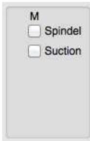
Hier können bis zu zehn Funktionen manuell geschaltet werden, sofern Ihr CNC-Controller über entsprechende Schaltausgänge verfügt. Die Belegung der Schalter wird in der Gerätekonfiguration (siehe Kapitel 4.2) definiert.
