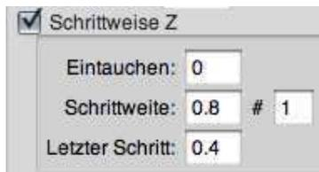
Canon unterstützt die stufenweise Bearbeitung von Werkstücken. Hier kann für ein Werkzeug angegeben werden, wie tief mit dem ersten Durchgang eingetaucht wird, in welchen Stufen die weiteren Durchgänge maximal bearbeitet werden dürfen und wieviel für den letzten Durchgang verbleiben soll. Es wird dabei maximal bis zur Eintauchtiefe der Lage eingetaucht. Der Schalter links oben dient zum Ein- und Ausschalten der stufenweisen Bearbeitung.
