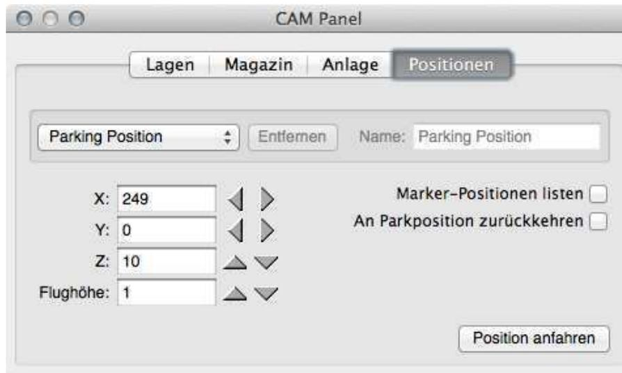
Doch wie gesagt - achten Sie beim Anfahren von gespeicherten Positionen vor allem immer darauf, dass die Z-Position nicht zu tief ist (z. B. durch ein höheres Werkstück oder eine andere Unterlage) wenn Sie einen solchen Positionsspeicher anfahren. Nachdem Sie *Position anfahren* angeklickt haben, gelangen Sie automatisch zurück ins Anlagensteuerungs-Panel.
