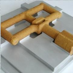
Das Bild zeigt ein Beispiel der Einzelfertigung einer Aufspannvorrichtung zum Entgraten von Gussteilen.
